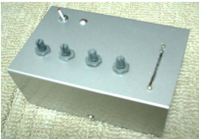
↑ 外見(上面) : 写真左斜め上・スイッチ 写真左から、ボリューム(4チャンネル)・スライ ドボリューム
